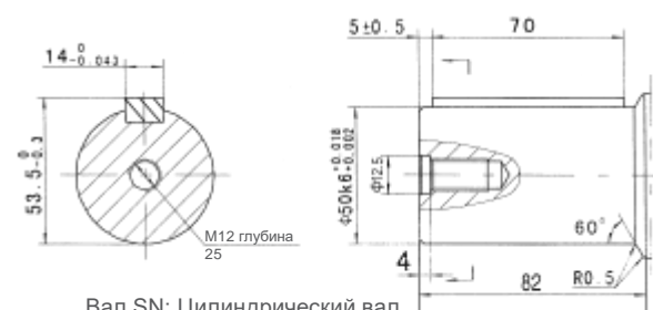
Вал SN: Цилиндрический вал \varnothing 50 Параллельная шпонка 14x9x70 Макс. Крутящий момент 210,7 даНм[18650 фунт-дюйм]
